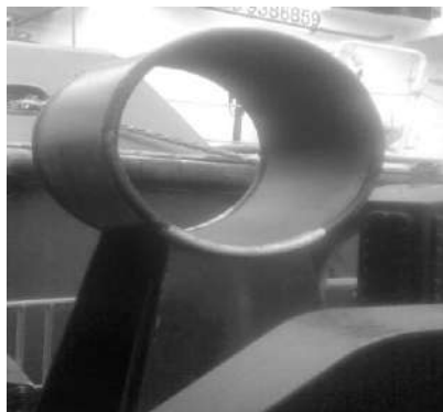
Рисунок 10 – Стационарний гоб (гоб) – пристрій для запобігання ризиканню буксирного троса (а), та Гоб (гоб) ланцюг – пристрій для запобігання ризиканню буксирного троса (б). Фото автора
