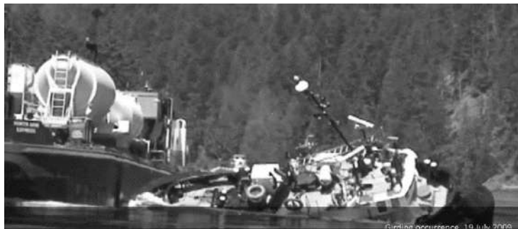
Рисунок 3 – Приклад гірдіngu, що трапився при буксируванні баржі [16]
