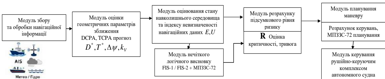
Рисунок 1 – Структурна схема системи оцінювання ризиків зіткнень MASS
