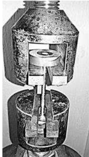
Рисунок 10 – Зразок зі знімними заплечиками, що багаторазово використовуються
