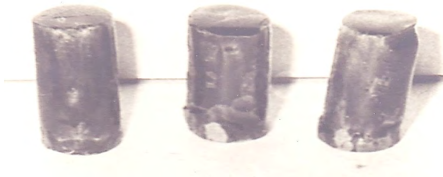
Рисунок 1 – Образцы после нагрева в расплаве стекла 291В1, где видна частично отслоившаяся стеклянная плёнка, покрытая сетью трещин
