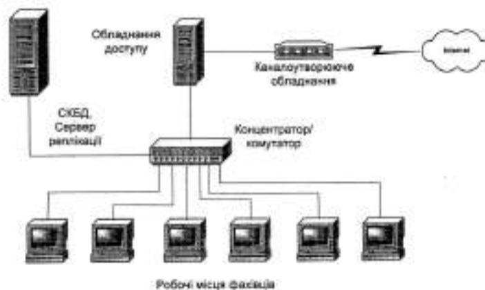
Рисунок 2 – Схема організації локальної обчислювальної мережі
