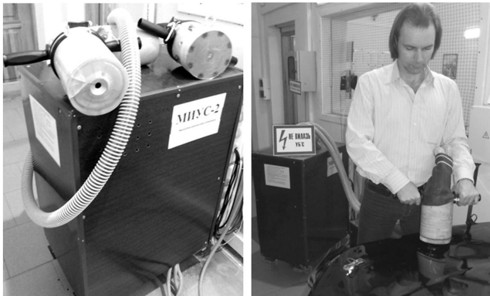
Рис. 2 – Экспериментальный комплекс внешней бесконтактной магнитно-импульсной рихтовки
