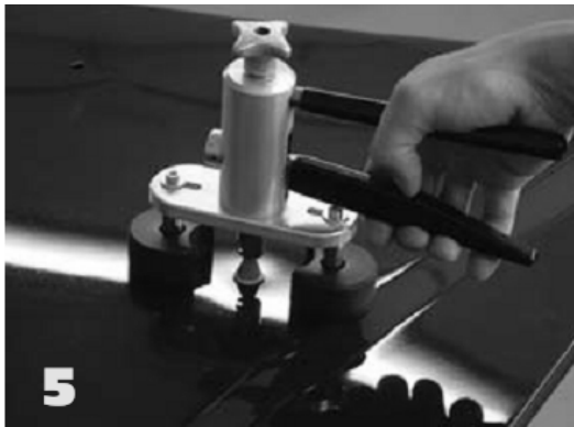
Рисунок 3 – Механические вытяжные устройства для внешнего устранения вмятин концерна «Beulentechnik AG»
