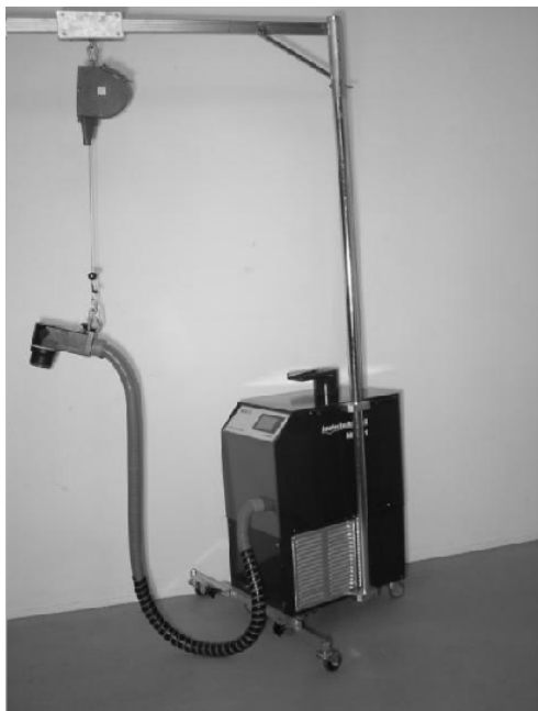
Рисунок 4 – Магнитное приспособление для удаления вмятин концерна «Beulentechnik AG»: а – источник мощности с инструментом; б – приспособление в действии
