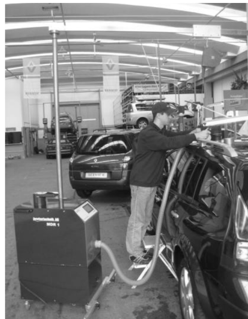
Рисунок 4 – Магнитное приспособление для удаления вмятин концерна «Beulentechnik AG»: а – источник мощности с инструментом; б – приспособление в действии
