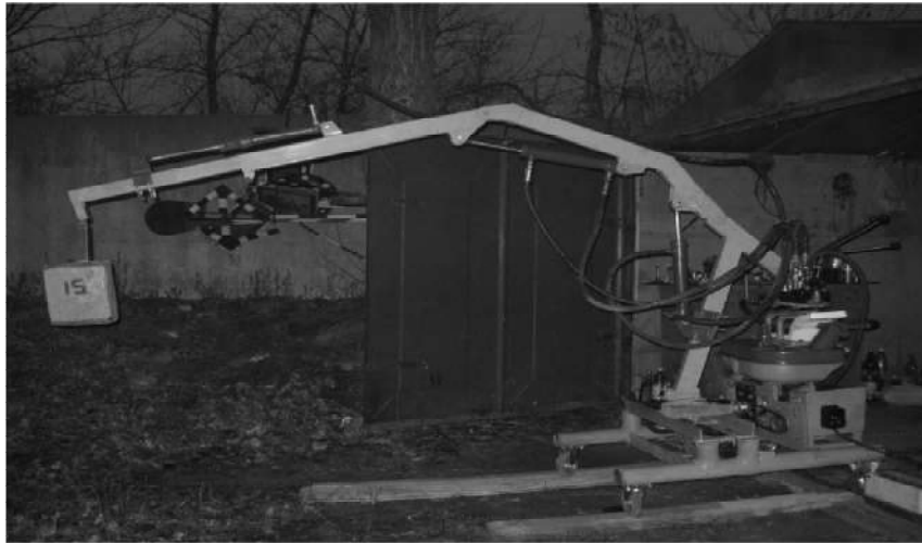
Рисунок 1 – Експериментальна установка крана-маніпулятора з гідроприводом
